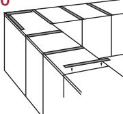
Para obtener el mejor resultado en climas norteños o en las Montañas Rocosas/Rocallosas secas, aclimate durante 48 horas. Instale separadores con un espesor de 1/8 pulgadas (0.32 centímetros/3.18 milímetros) entre los gabinetes/muebles bajos y las encimeras/los mostradores para permitir la circulación del aire a ambos lados de la encimera/del mostrador.
