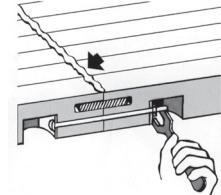
Las encimeras/los mostradores "custom" de CaféCountertops están construidas/os a la medida con juntas de lengüeta postiza/montaje/ranuras típicamente preparadas en fábrica para pernos conectores. Los pernos deberían estar ajustados pero no demasiado tensos. Tableros sin juntas de lengüeta postiza/montaje/ranuras pueden ser (co)lindados con pernos tirañodo o placas conectadoras/de anclaje (no incluidos/as). Llene el hueco solamente con silicona. No utilice pegamento.
