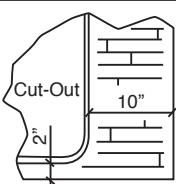
Recortes ubicados menos de 10 pulgadas/25 centímetros del final de la superficie de trabajo pueden ocasionar que la madera se agriete y anulará la garantía del producto. Selle todo borde cortado y dentro de los agujeros para grifos.
