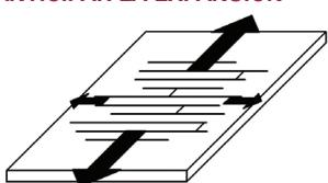
Las superficies de trabajo de madera se expanden y se contraen de adelante hacia atrás (a través de la veta). Permita que se expanda como se muestra arriba o la superficie se agrietará.
