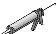
Utilice silicona de alta calidad para fregaderos, junturas, huecos en las paredes, etcétera. Nunca utilice adhesivos para la construcción con tableros de madera. No recomendamos el uso de silicona en lugar de tornillos pasadores de instalación.
